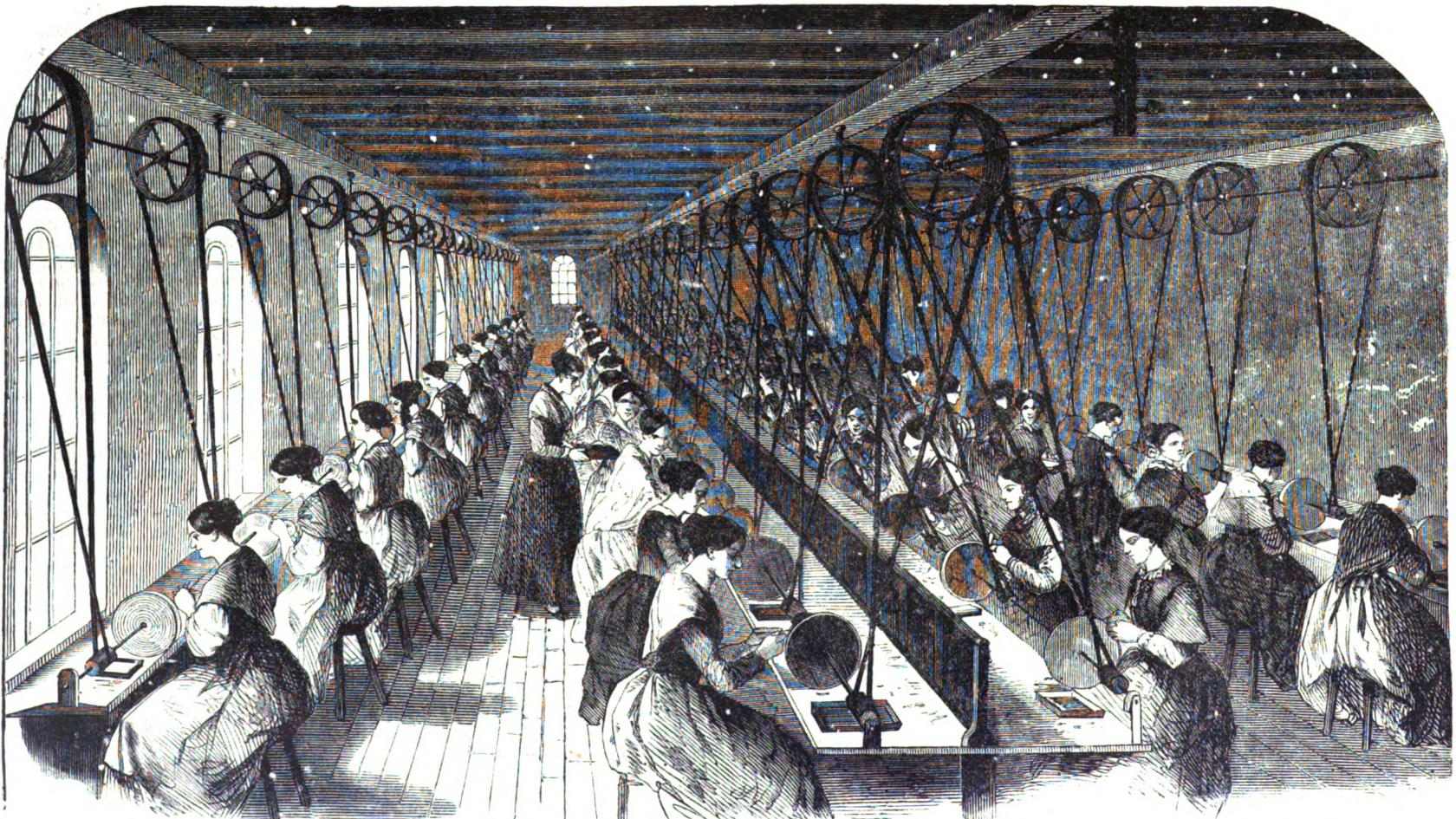
Die Fabrication der Cementfeder: Der Federschleif-Saal.
