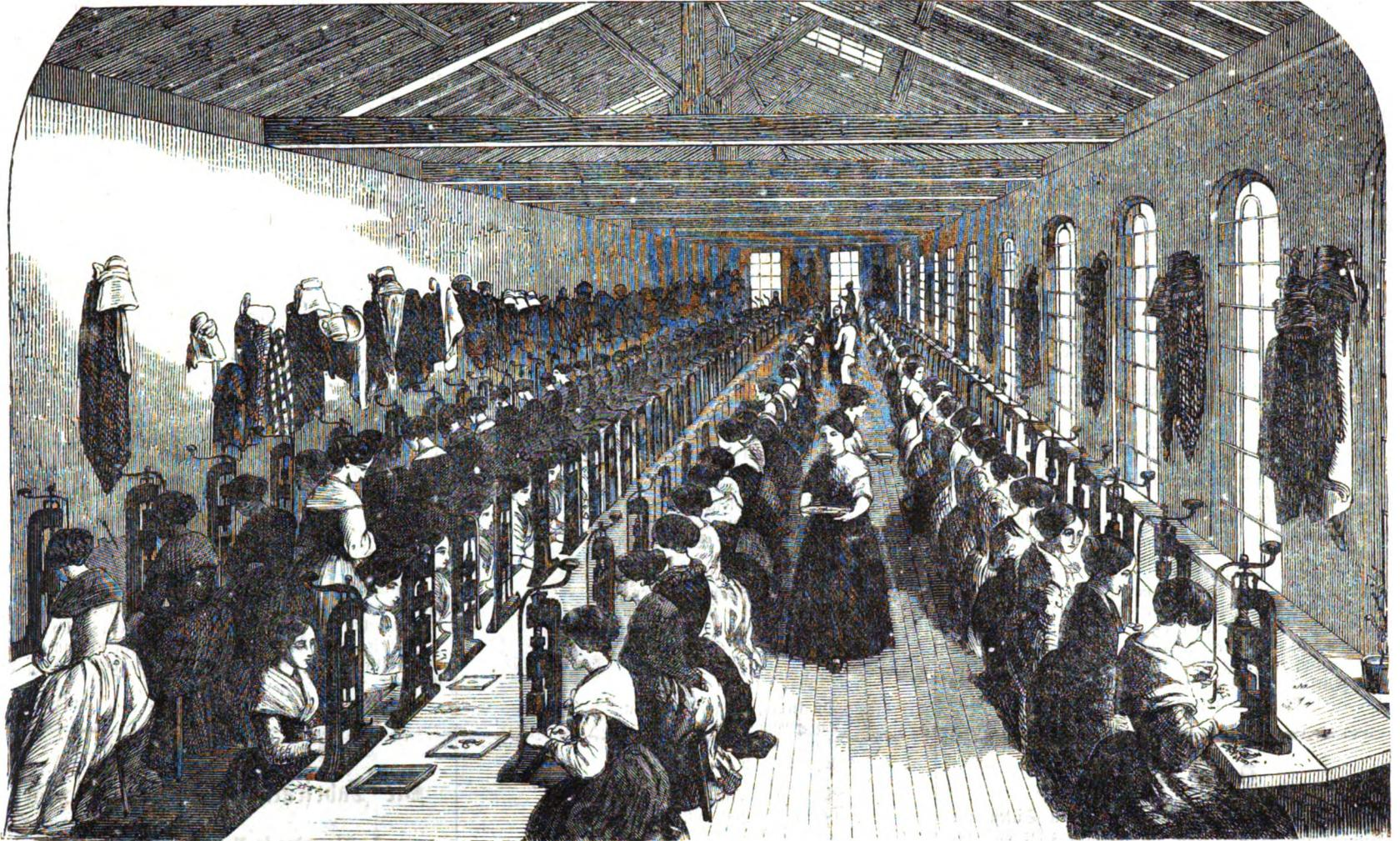
Die Fabrication der Cementfeder: Der Federspalt-Saal.
